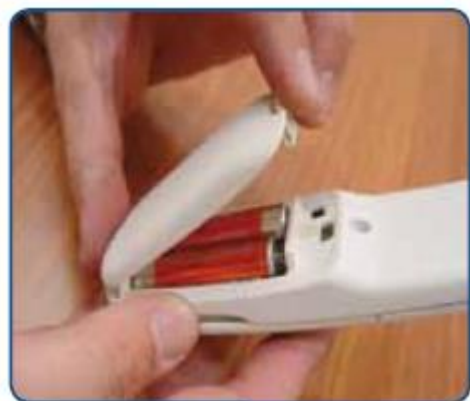
Obrázok 4.1 Výmena batérií v ovládači v staniách
